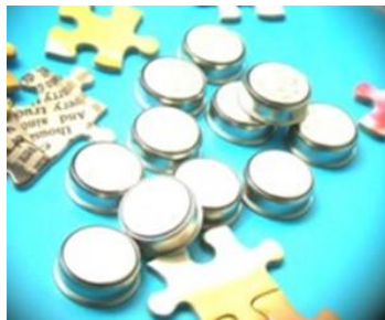
直径が1円玉より小さいサイズのデータロガーで計測
